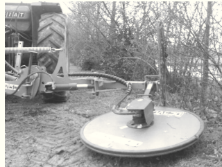
Le broyeur satellite, très efficace avec une clôture en piquets en bois.
