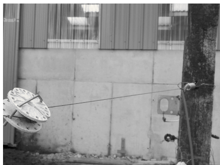
Le tendeur rotatif au premier plan et le ressort proche du poteau au deuxième plan. (3.60€/tendeur)
