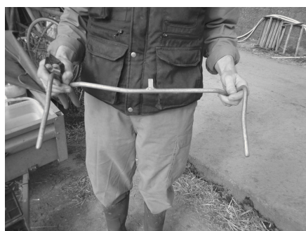
La manivelle est fixée sur le tendeur rotatif. En la tournant, on tends le fil.
