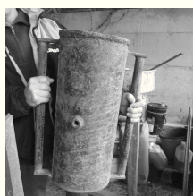
Un système de cloche pour enfoncer les poteaux.
